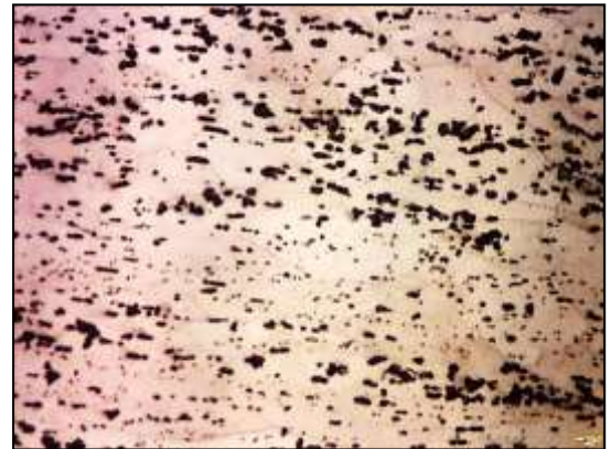
Figura 13 – Micrografía de la muestra con recocido de ablandamiento laminada en caliente con un 86 % de deformación acumulada 200x.
