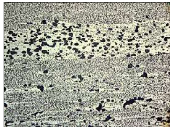
Figura 14 – Micrografía de la muestra con recocido de ablandamiento hasta 290 °C y temple, con un 85,7 % de deformación acumulada, 200x.
