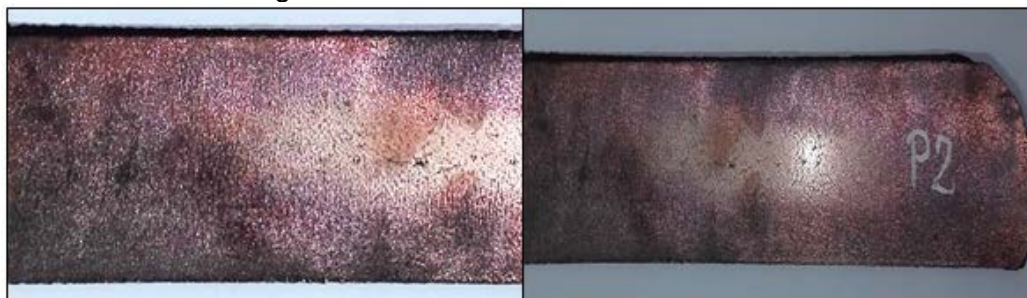
Figura 2: Chapas de Cu-Ag-Zr en proceso de laminación para alcanzar el espesor final de 3mm y luego ser soldadas por FSW.
