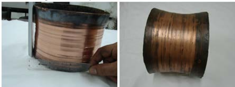
Figura 8: Se presentan dos fotografías de distintas etapas del repujado. Superior corresponde a la primera etapa y la segunda luego del recocido de recristalización aplicado para darle el conformado final a la pieza.
