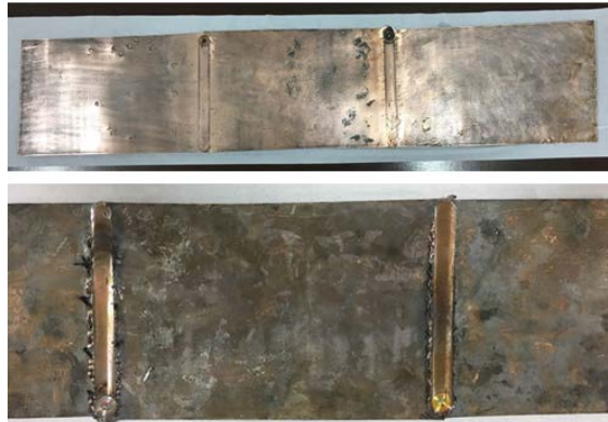
Figura 3: Fotografías correspondientes a las chapas de Cu-Ag-Zr soldadas por FSW para luego rolar un cilindro de 200 mm de diámetro.
