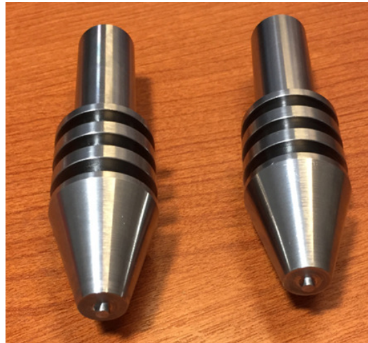
Figura 3: Herramienta diseñada en ProInTec I&D utilizada en FSW
