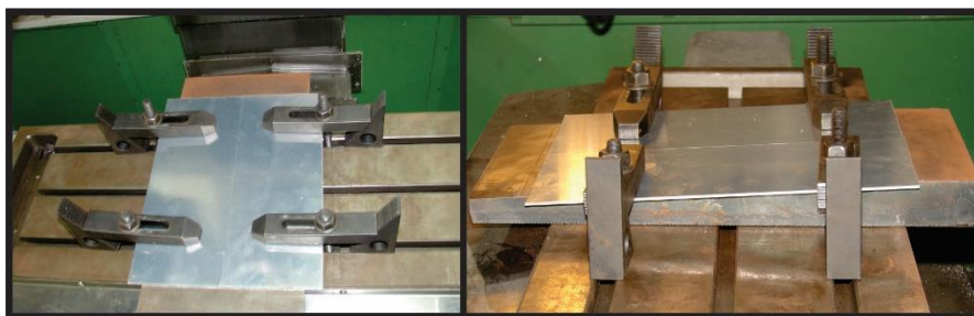
Figura 2: Chapas dispuestas en respaldo para ser soldadas.
